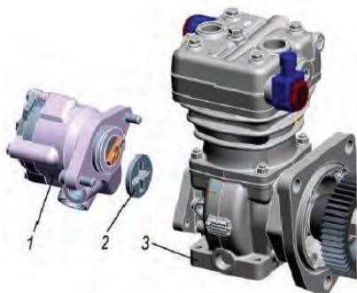
Рисунок 3. Насос гидроусилителя руля 1 - насос; 2 - шайба; 3 - компрессор
